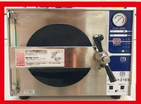
一見、頑丈な電子レンジのように見えますが、これは「高圧蒸気滅菌器」、
